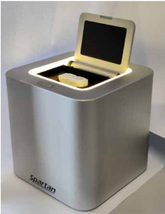
Figuur 2. Spartan Cube; hierin dienen 3 swabs vanuit het wangslimvlies geplaatst te worden, waarna een PCR-analyse uitgevoerd zal worden.
